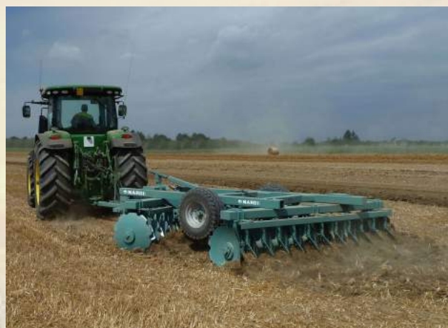
Grade Hidráulica 26FCIM/G/66 Potência de tractor (hp): 120-140 Nº de discos: 26 peso aprox. (kg): 1810
