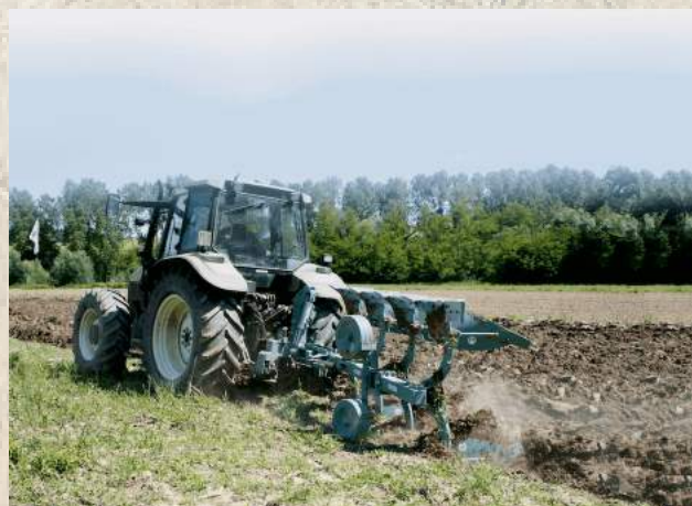
Charrua de aiveca reversível NX10E/4EL5R Potência de tractor (hp): 95-115 Nrº de aivecas: 4 (3+1) Peso aprox. (kg): 850
