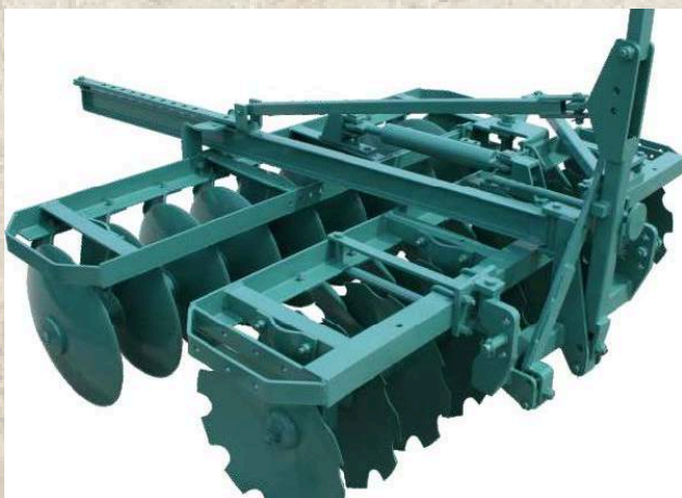
Grade 22 FLPF/56 Potência de tractor (hp): 60-70 Nº de discos: 22 Peso aprox. (kg): 780
