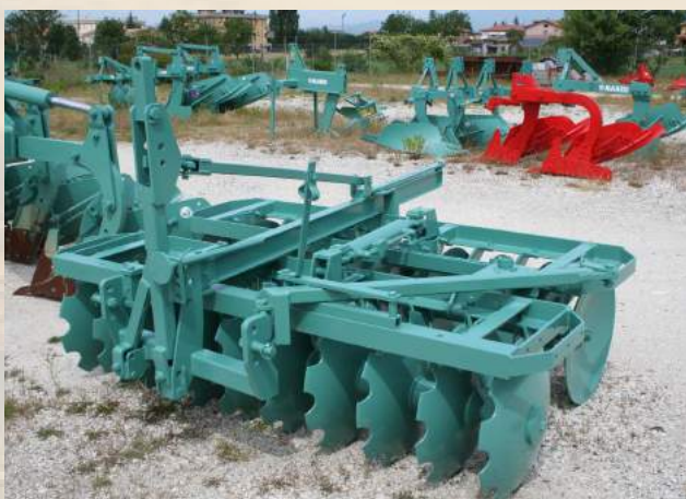
Grade 24 FVPT/61 Potência de tractor (hp): 90-100 Nº de discos: 24 Comp. de abertura (cm): 275 Peso aprox.(kg): 1230
