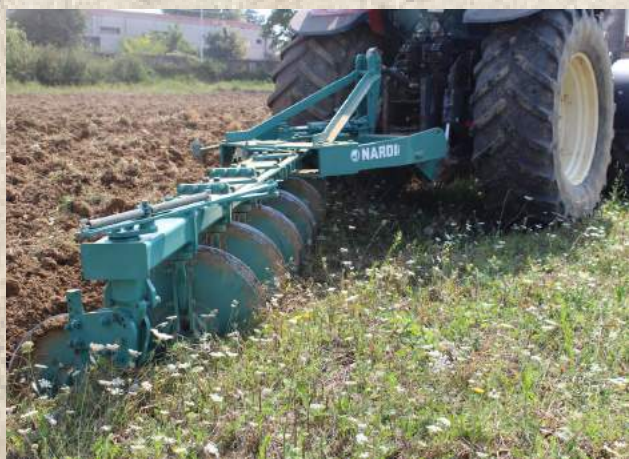
Charrua de discos PDE 80 Nrº de discos: 5 Potência do tractor (hp): 90-110 Peso aprox. (kg): 725
